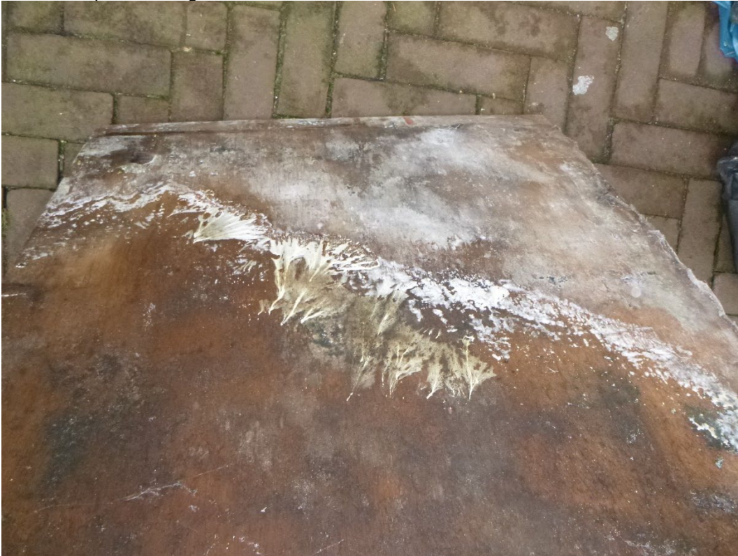
Foto 6: balk is aangetast door bruinrot.
